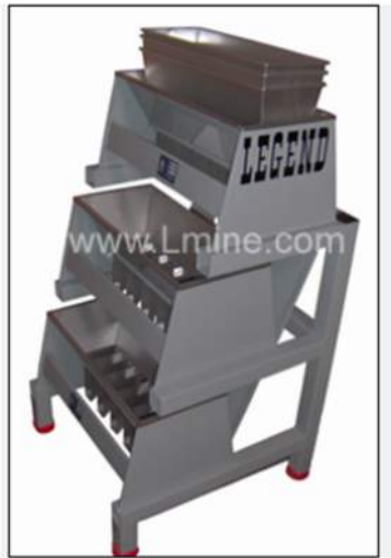
Figur 10. Neddelning i tre steg till 1/8 av ursprungsprov.
