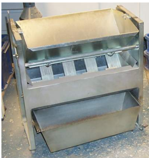
Figur 5. Större spaltneddelare med möjlighet att ställa spaltöppning och antal neddelningskanaler.
