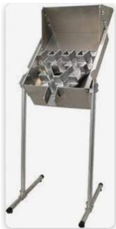
Figur 12. Lutande neddelare i form av en så kallad "Sample Splitter".
